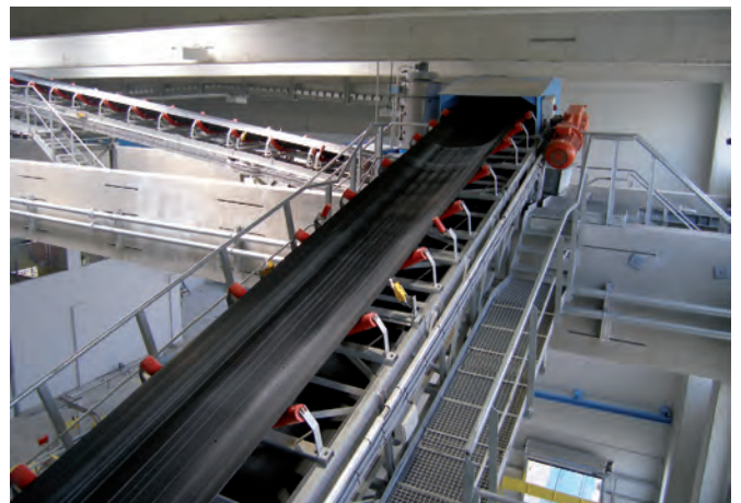
От станции дозирования до смесительной установки заполнители транспортируются посредством двух длинных ленточных конвейеров шириной 1200 мм
