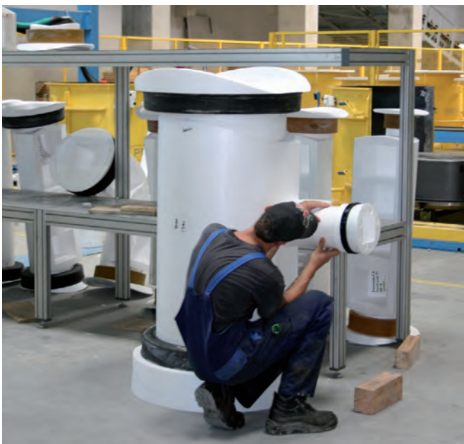
Изготовление индивидуальных шаблонов для водоводов
