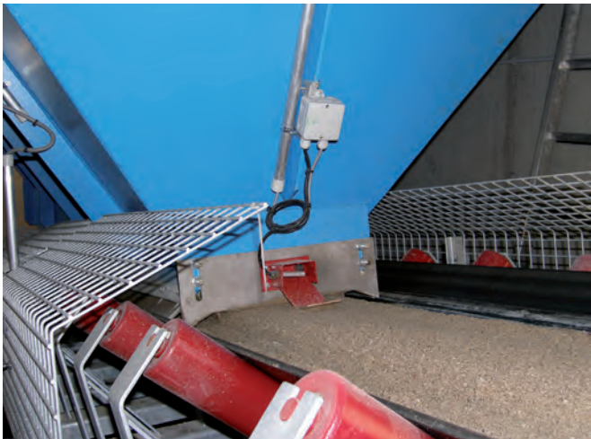
Ленточный питатель гарантирует низкий уровень шума и бесперебойную подачу материала
