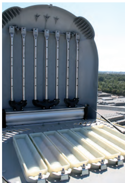
Фильтры гарантируют содержание остаточной пыли в воздухе менее 20 мг / м 3
