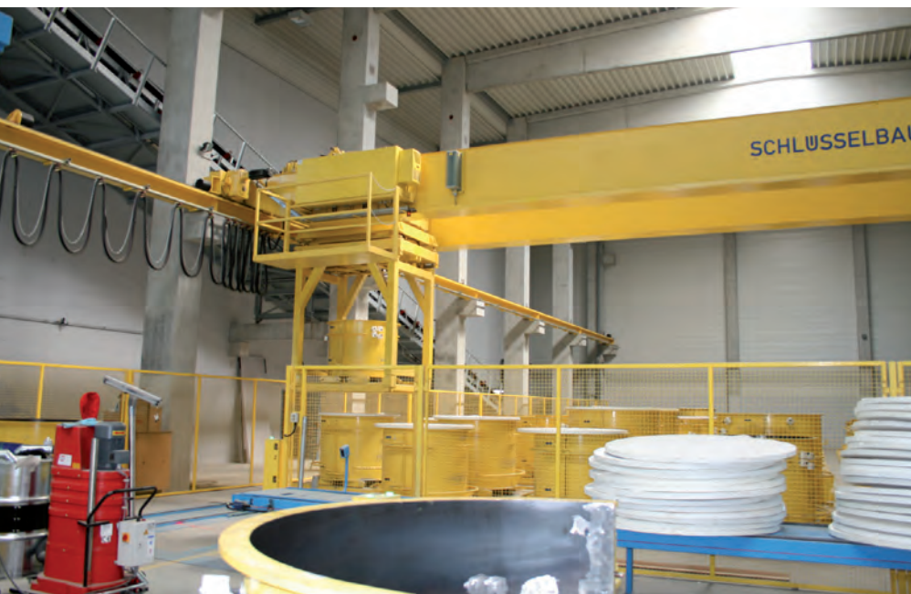
Кран Transexact доставляет форму на станцию распалубки
